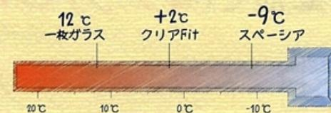
※算出条件：室内温度20℃、室内相対湿度70%、室内自然対流、戸外風速3.5m/sの場合
